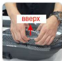
(2) Откройте крышку батарейного отсека, потянув её вверх.
