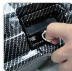
(3) Потяните батарею в сторону по горизонтали, а затем извлеките её.
