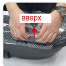
(2) Откройте крышку аккумуляторного отсека, потянув её вверх
