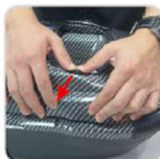
(2) Откройте крышку батарейного отсека, потянув её вверх.
